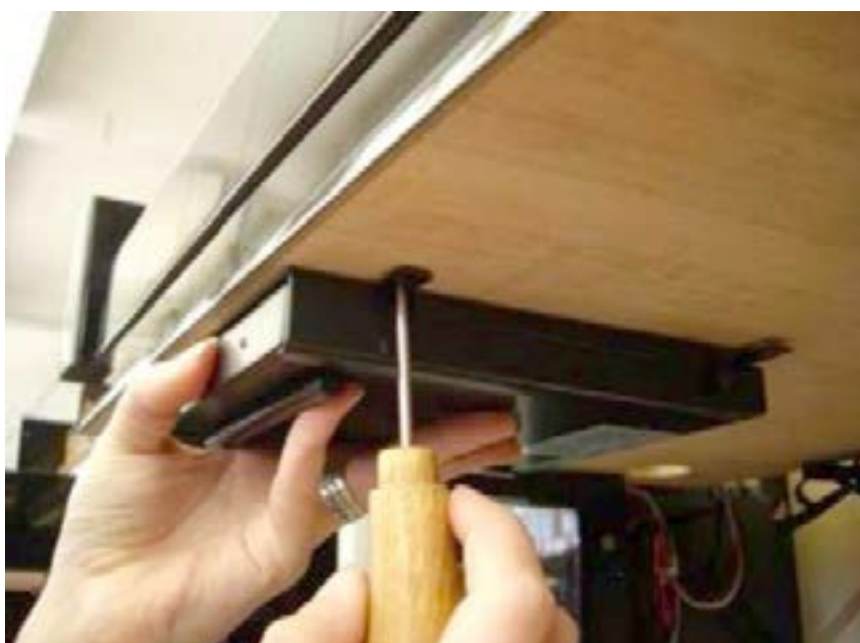
(7) Module de commande avec écran tactile (dans tiroir coulissant fixé par quatre vis cruciformes)
