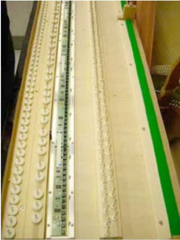
(4) Rail des capteurs de touches avec vis et entretoises
