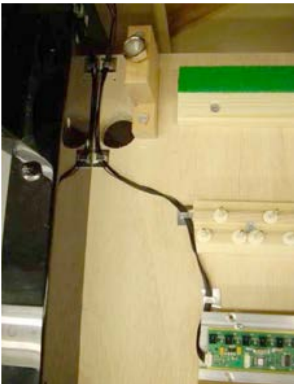
(5) Flachbandkabel zur Sensorikleiste
